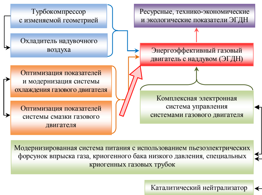
Рис.1. Схема энергоэффективности газомоторной техники при комплексной оптимизации механизмов и систем газового двигателя
