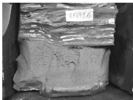
Рис.3. Вид изломов технологических проб от верха и низа листа толщиной 100 мм, изготовленного из листового слитка высокопрочной корпусной стали массой 20,4 т
