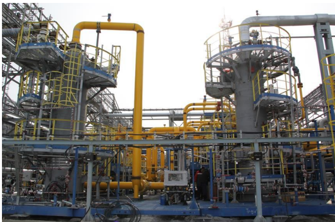
Рис.2. Экспериментальная установка низкотемпературной сепарации с пластинчатыми теплообменниками
