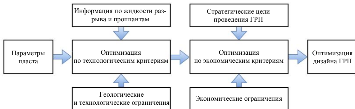
Рис. 2. Принципиальная схема оптимизации ГРП
