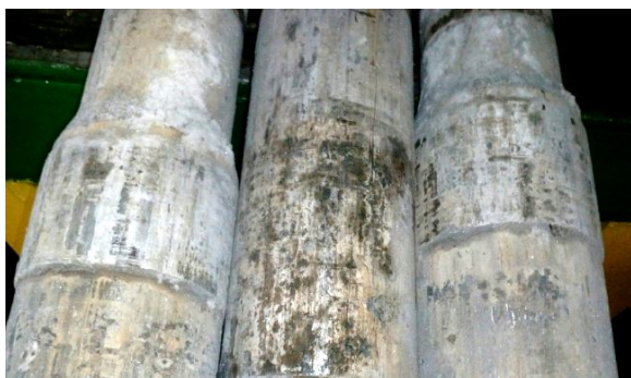
Рис.6. Фрагменты замков СБТ без наплавки (в середине) и с хардбендингом
