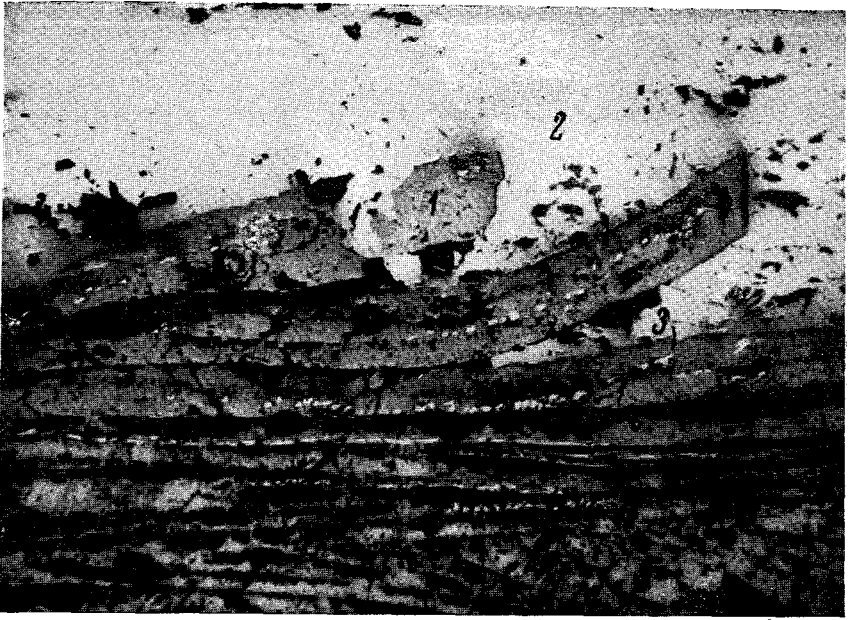
Рис. 5. Мушкетовит (пластинки) с реликтами гематита в центре: 1 — гематит; 2 — халькопирит-2; 3 — мушкетовит, \times 50
