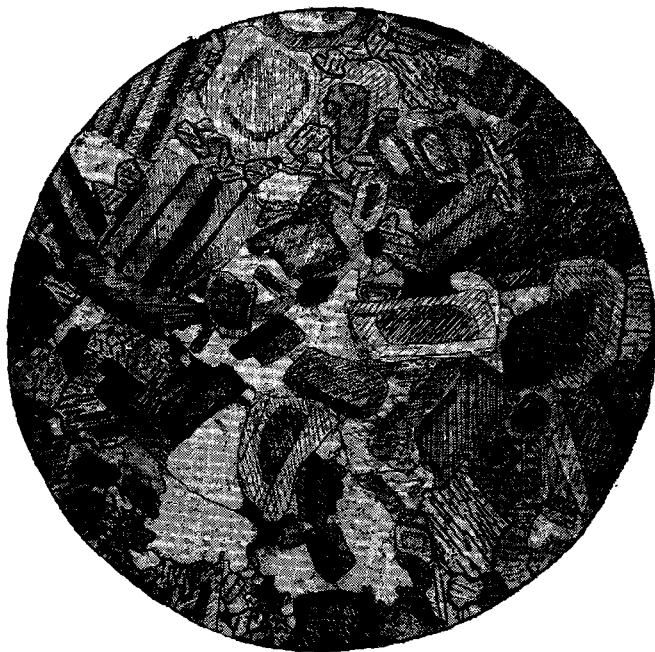
Рис. 3. Кварцевый диоритовый порфирит с порфировидной криптовой структурой. Скв. 530, глубина 536,8 м. Николи скрещены. \times 15
