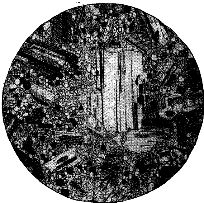
Рис. 2. Гранодиорит-порфир порфировидной структуры с гранулитовой структурой основной массы. Скв. 12, глубина 508 м. Николи скрещены. \times 15
