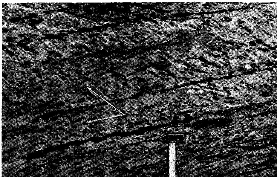
Рис. Два основных направления ориентировки пятен и полос силикатного состава в апатитовой массе богатой апатитовой руды. Рудник Кукисвумчорр. Горизонт + 392, орт 38, западная стенка, в 80 м от восточного откаточного штрека.
