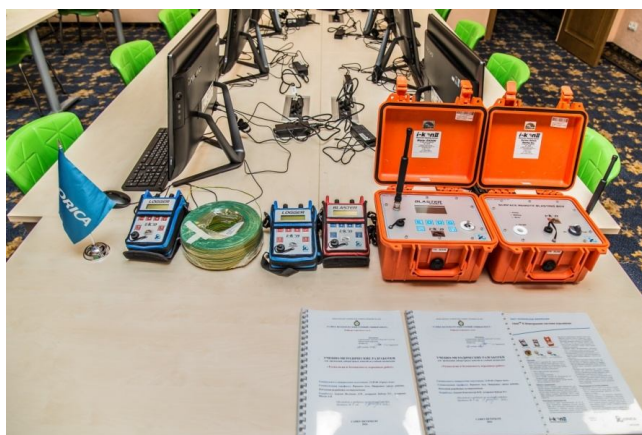
Рис.2. Электронная система инициирования i-kon™ II и система дистанционного радиовзрыва i-kon™ II SURBS
