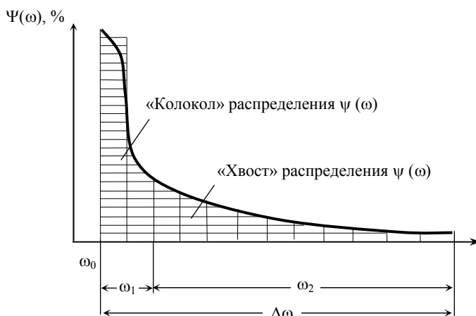
Рис.3. Моделирование прочностной неоднородности материала посредством функции \psi(\omega) распределения по структурным элементам материала параметра \omega прочностного состояния
