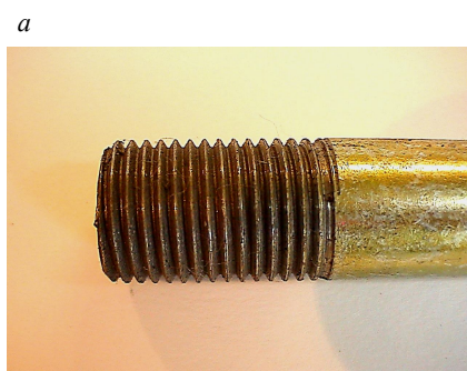
Рис.2. Фрагмент шпильки с резьбой нарезанной (а) и детали после ОУЭМО (б)
