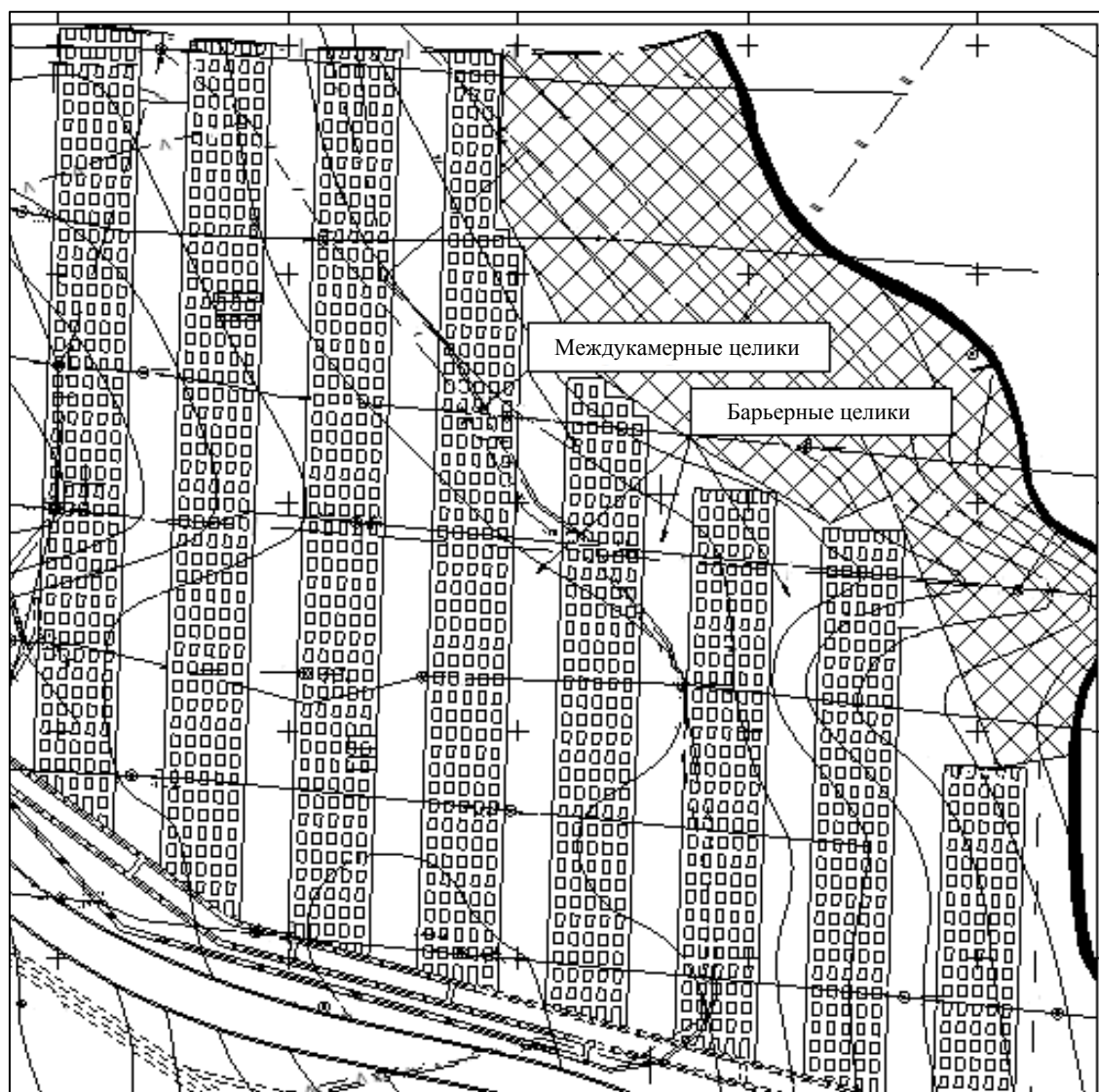
Рис.3. Схема участка поля шахты Нуйбео для отработки короткими забоями
