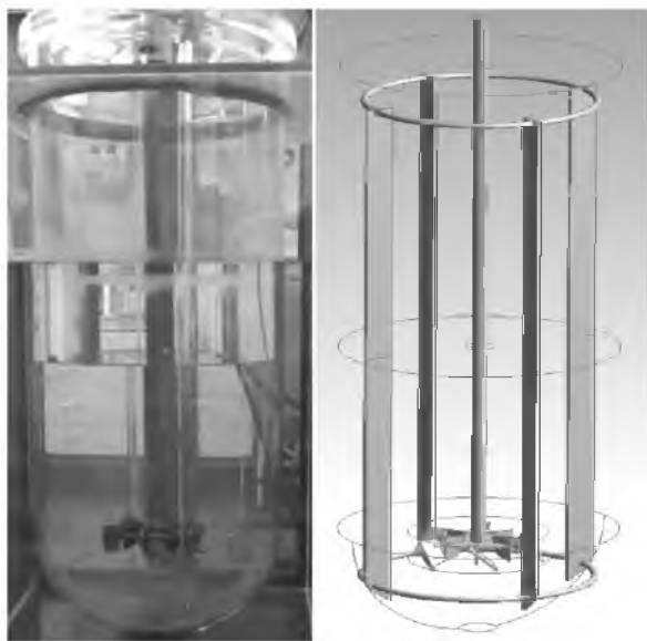
Рис.1. Исследуемый реактор и его геометрическая модель, построенная в программе GAMBIT
