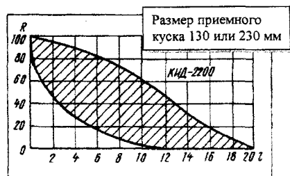
Рис.5. Гранулометрический состав продукта дробилок КИД различных размеров применительно к минералу с прочностью 18-20 по шкале Протодьяконова Размер приемного куска зависит от формы дробящей полости и не влияет на крупность продукта
