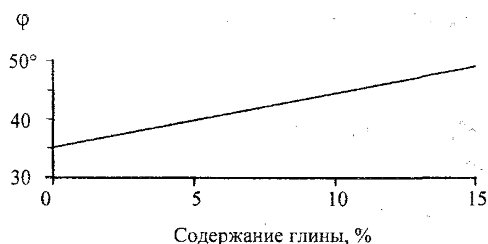
Рис.2. Зависимость угла внутреннего трения породы \varphi от содержания глины в буровом растворе
