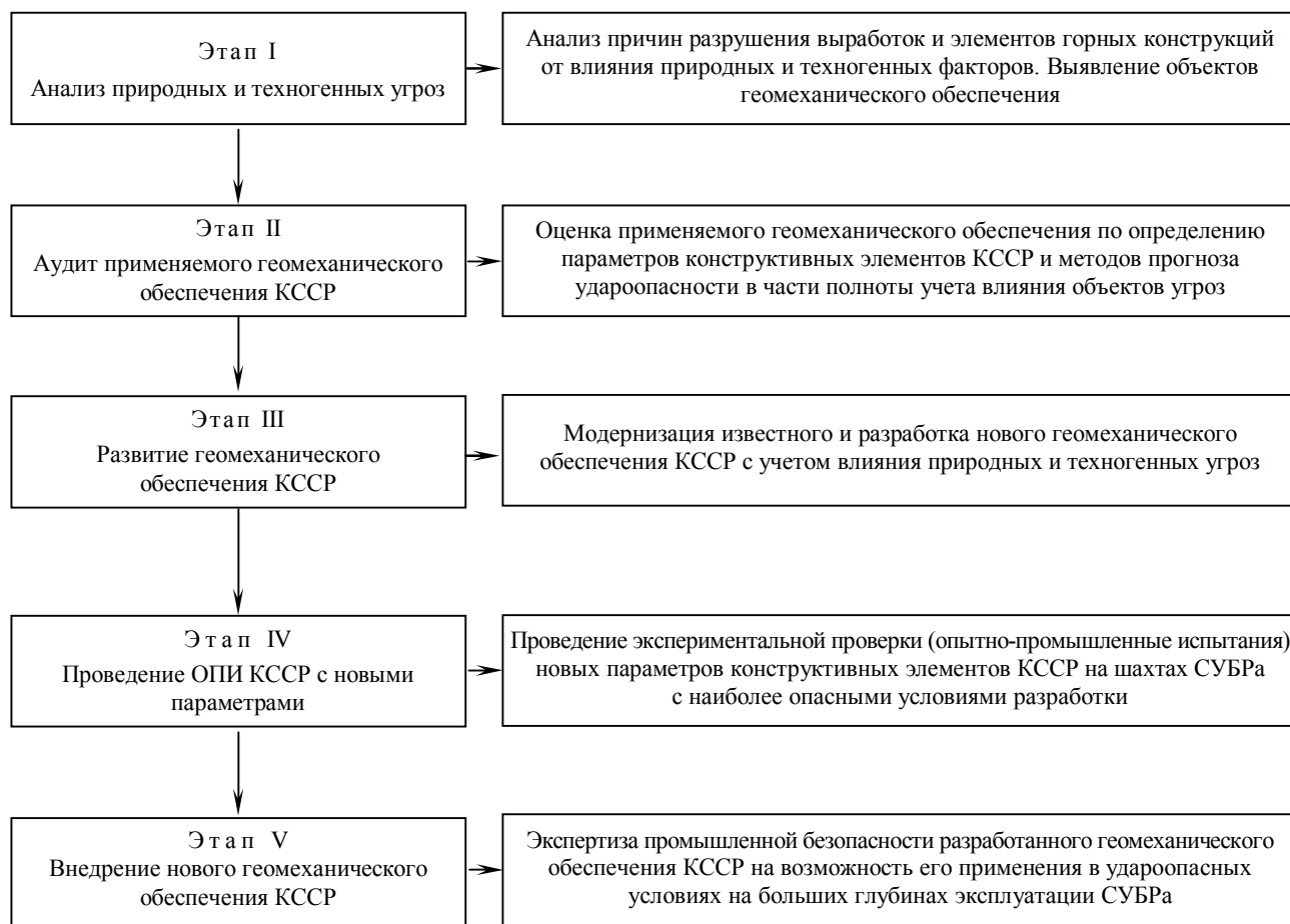
Рис. 1. Концепция снижения удароопасности при применении КССР на больших глубинах
