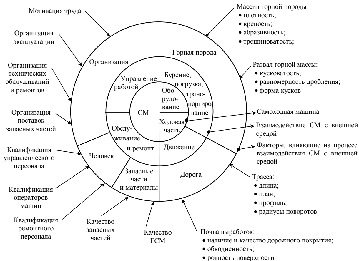
Рис.2. Схема влияния условий эксплуатации на эффективность работы самоходной машины
