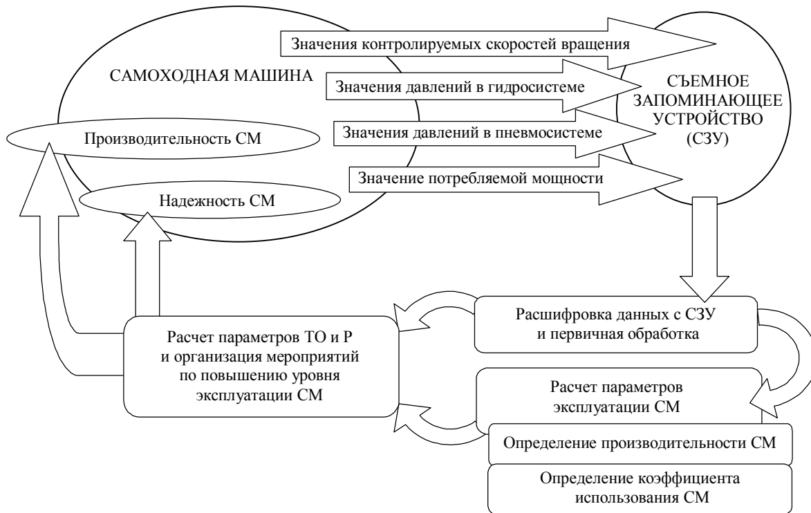
Рис.3. Схема мониторинга самоходной машины
