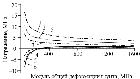
Рис.2. Зависимость изменения тангенциальных напряжений на внутреннем контуре обделки от модуля деформации окружающего массива (ребро, \lambda = 0,4 )
